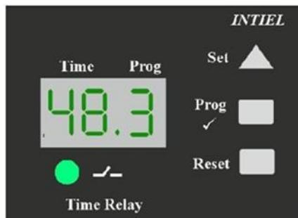
1. Индикация « **Time** » - два последовательных цифровых дисплея, показывающих время от 00 до 99.
