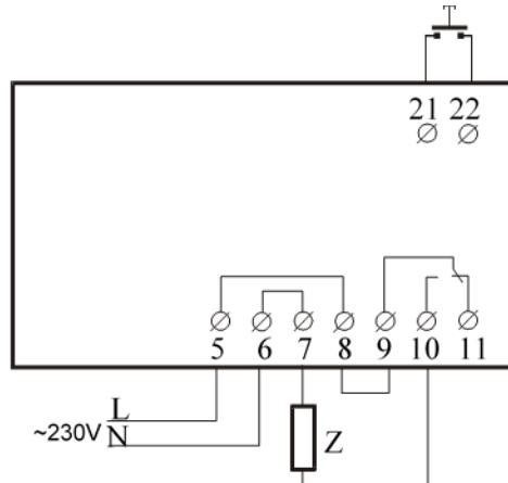
На рисунке выше показан пример схемы электропроводки, где потребитель Z работает при напряжении  $\sim 230$  В. Перемычку между выводами 8 и 9 нельзя ставить, если потребитель работает с напряжением, отличным от  $\sim 230$  В. ]
