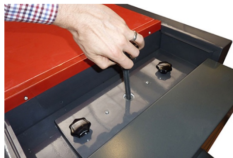
Демонстрация оперативной очистки трубчатого теплообменника
