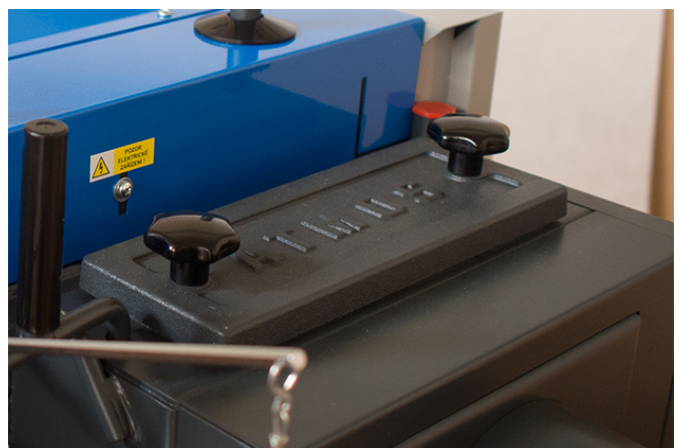
Katla augšējais tīrīšanas vāks
